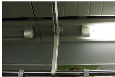
地下鉄の電車内。車内灯を半分に減らして節電対応。南武線など地上を走る電車は日中全消灯し、駅構造やトンネルなど暗い所に入る時だけ点灯していた。各社各様で工夫されている。
